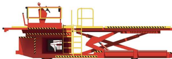
plate-forme F élévatrice automotrice container/pallet loader cargador M de contenedores M y plataformas F Ladegerät N für Paletten F und Container M elevatore M per containers M e palette F di carico M
